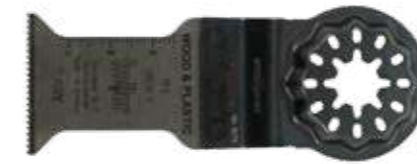
Пильное полотно из высокоуглеродистой стали для дерева и пластмассы, 50 x 35 мм Дерево, гипс и пластмасса. Высокая скорость Арт. №» 29530 7 & 29531 4
